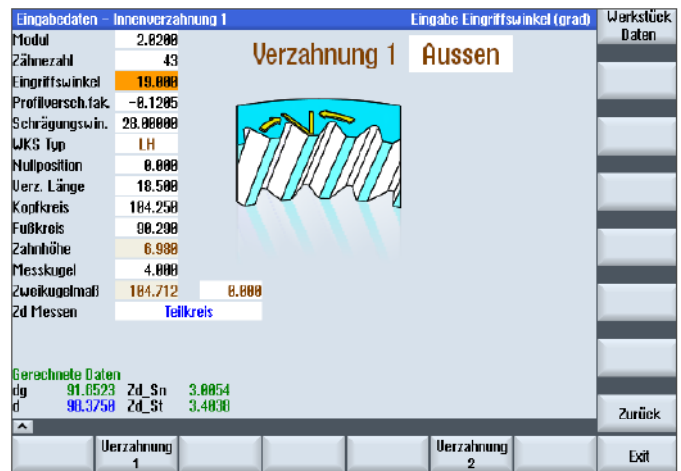
調整加工中的軸交角程式畫面
