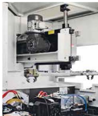
旋轉機械手裝置 (桁架或機械手可供選擇)
