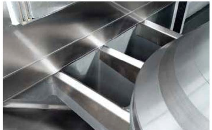
乾式切削工作區域以不銹鋼表面覆蓋
