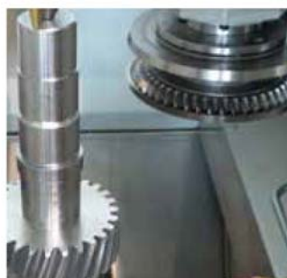
整合的輔助功能 - 在一個刀具臂上安裝有倒角與去毛邊的組合刀具
