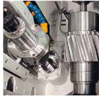
高性能的大模數大切削量滾齒加工
