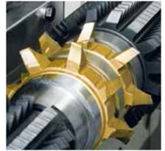
滾刀輪安裝專用倒角去毛邊刀具進行倒角與去毛邊加工
