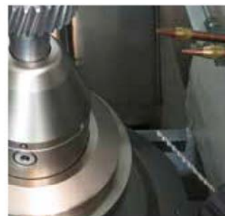
整合的輔助功能 - 鑽孔功能
