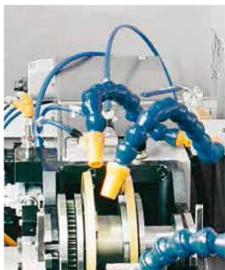
臥式工件軸便於加工切屑下落
