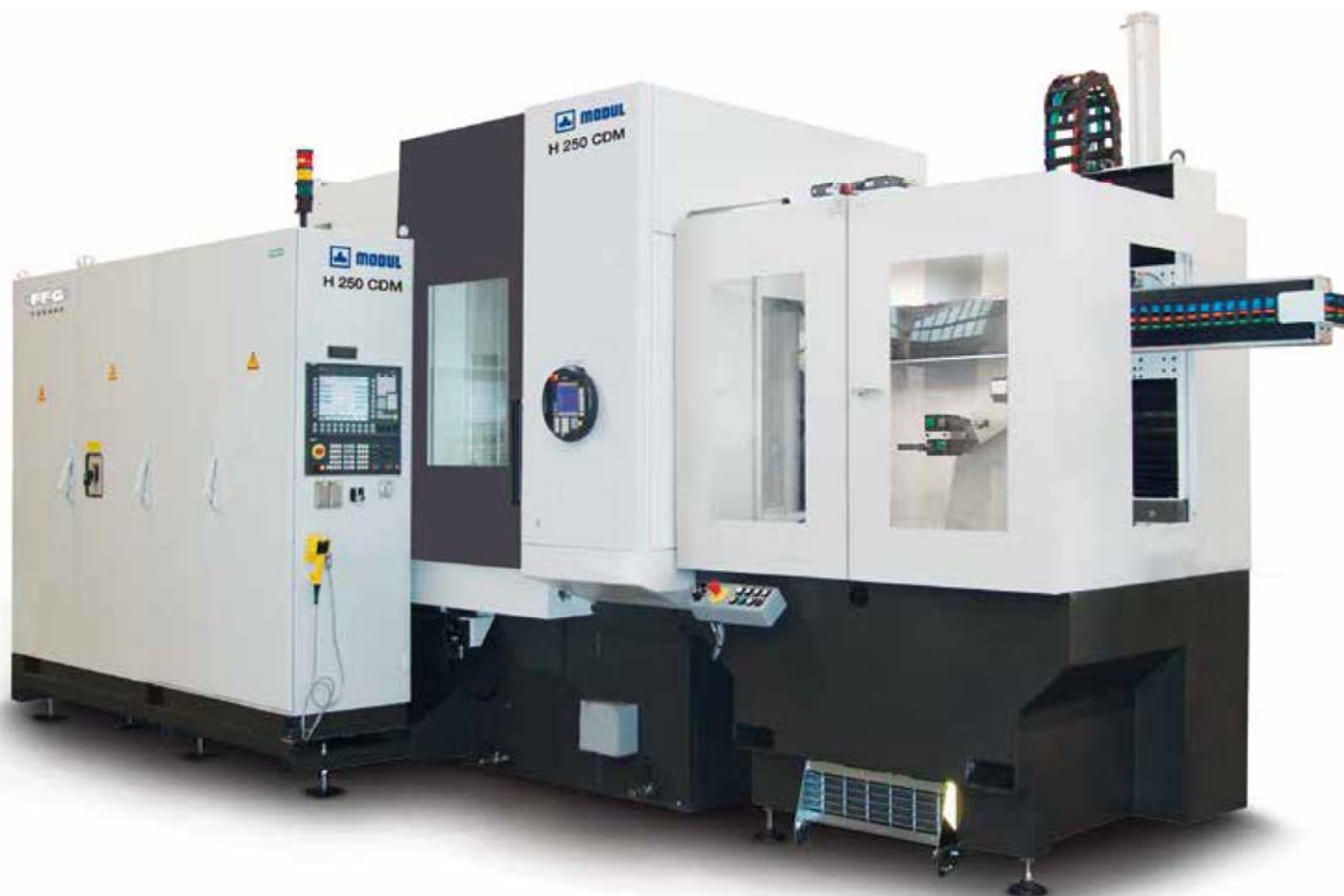
滾齒機與倒角/去毛邊機的整合式機床
