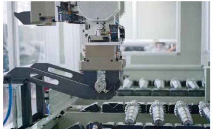
整合的重型工件桁架機械手和料倉
