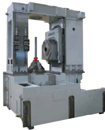
封閉式框架結構確保機床最大的剛性
