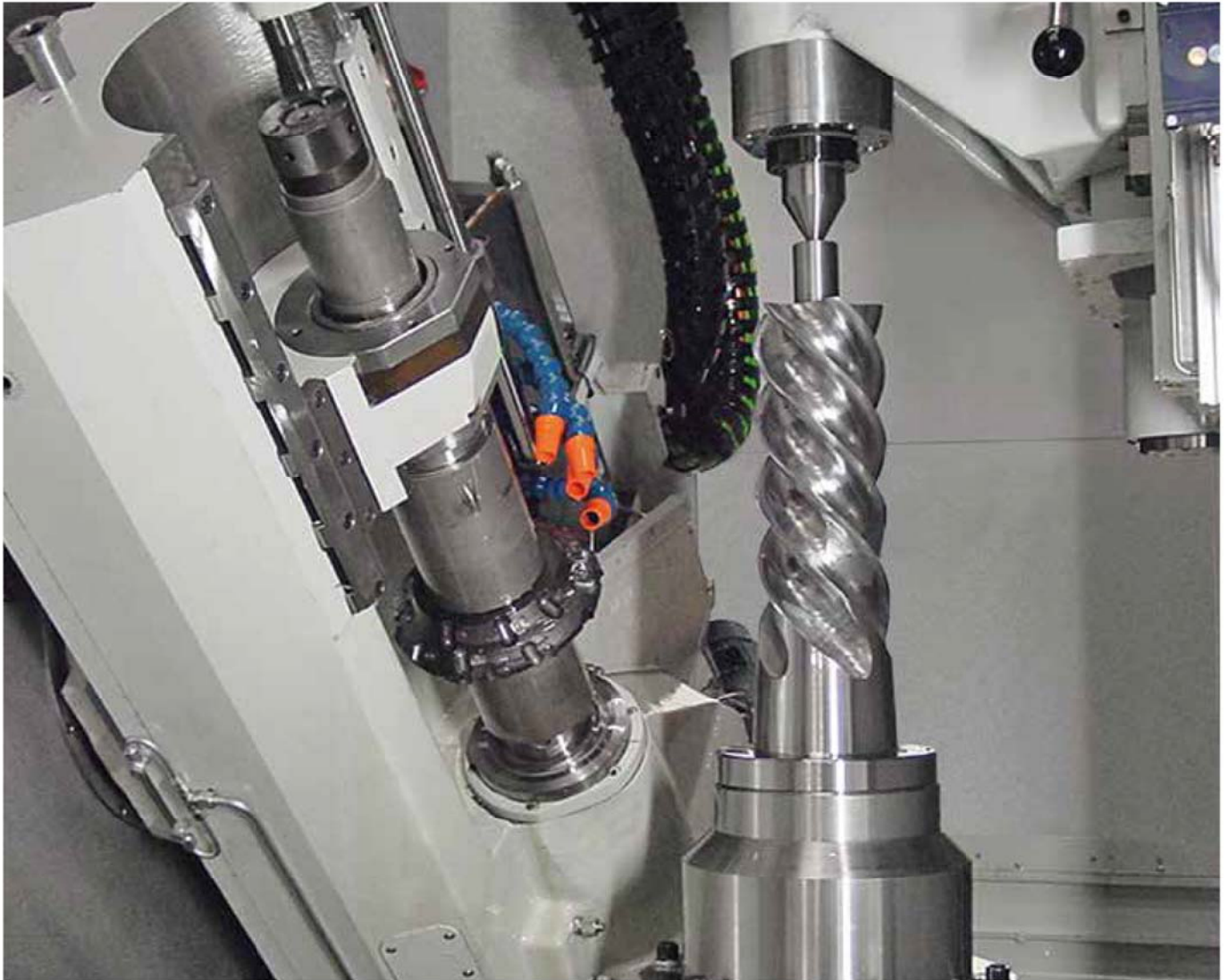
H 600 配備了強力切削 (PowerCutting) 的選配項目後特別適合採用滾齒或是銑齒加工大型轉子
