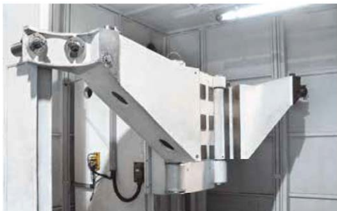
頂心臂可以完全的旋開，讓工件更換更方便
