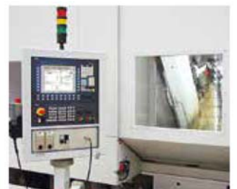
採用西門子 840 D SL 控制器與 MODUL 易學易用的人機介面
