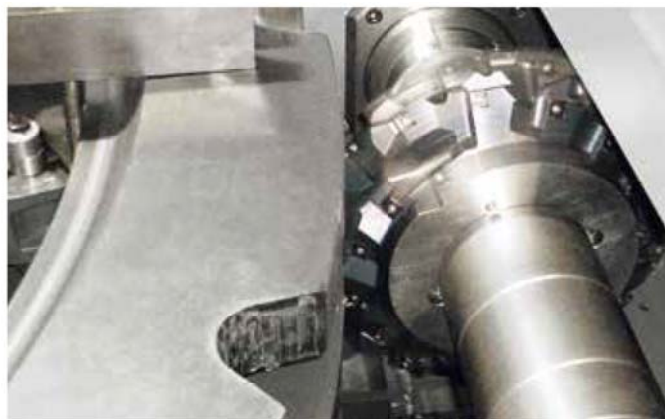
大型鏈條齒齒輪以成形銑齒法加工
